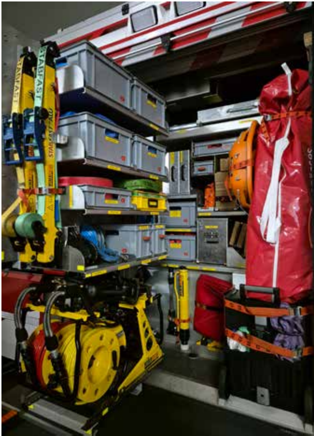
Weber Hydraulik Aggregat E50T mit Schneidgerät RSX20-107 Plus & Spreitzer SP53BS
