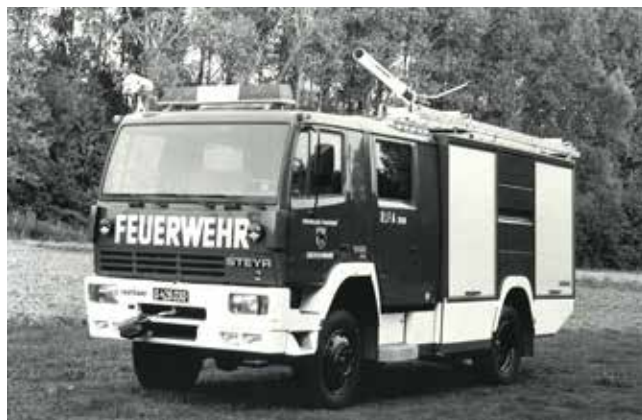
RLFA 2000 mit Bergeschere und Atemschutzausrüstung
